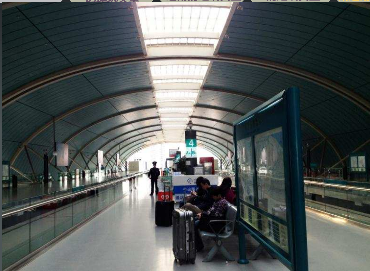
■用金属拱支承顶盖的某轨道交通站台
